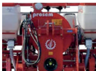
Turbina de gran capacidad y vacuómetro.
