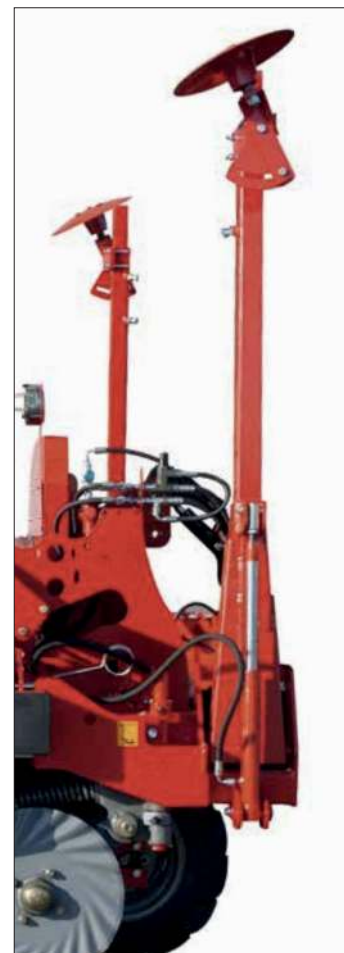
Trazadores hidráulicos de disco con fusible.
