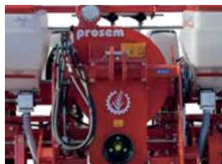
Turbina de gran capacidad y vacuómetro.
