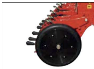
Rueda de compresión en V 2" con presión y ángulo regulable.
